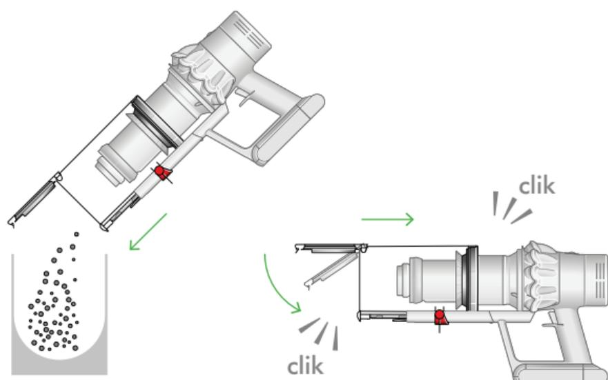
Rimozione e sostituzione del contenitore
