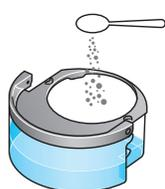
Отмерьте 150 г лимонной кислоты и засыпьте в резервуар с водой.
