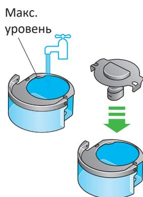
Заполните резервуар до максимального уровня, вытрите излишки воды и закройте крышку, убедившись, что фиксаторы надежно закрыты.
