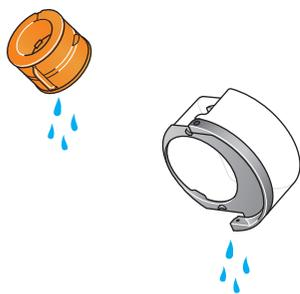
Откройте крышку, извлеките испаритель из резервуара и сполосните под холодной водой из-под крана.
