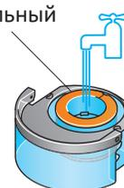
Поместите испаритель в резервуар для воды. Налейте в резервуар холодной воды из крана до отметки Max.
