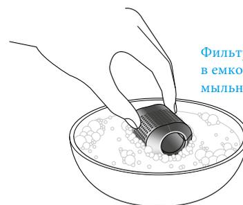
Фильтр помещается в емкость с мыльной водой
