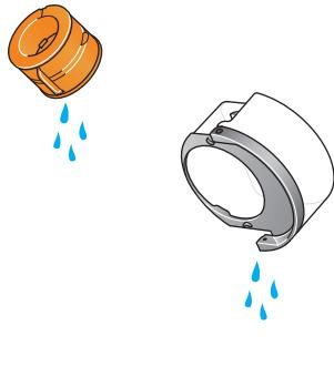
Откройте крышку, извлеките испаритель из резервуара и сполосните под холодной водой из под крана.
