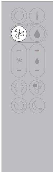
Установите увлажнитель-очиститель воздуха Dyson в режим автоматической очистки, и встроенные датчики будут автоматически регулировать настройки вашего устройства в зависимости от качества воздуха.
